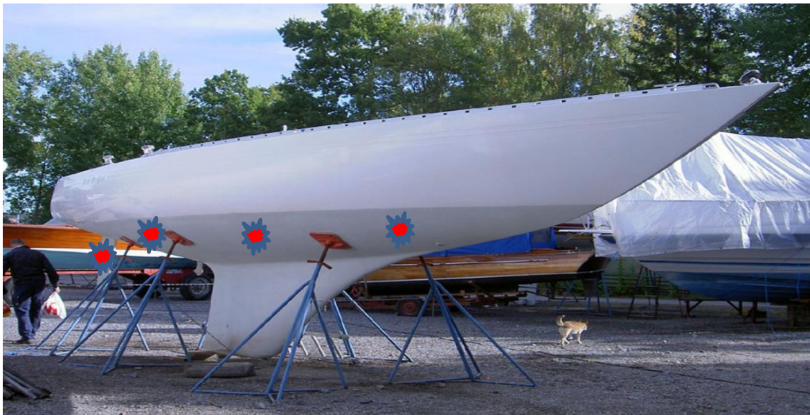
Figur 1. Mätpunkter på båtar mätta av Happy Boat AB. Mätningar utfördes 10-20 cm nedanför vattenlinjen på både styrbord och babord sida enligt bilden (styrbord bak, styrbord mitt, styrbord för, babord för, babord mitt och babord bak plus ömse sidor av rodret). Motorbåtar mättes på aktern istället för roder.
